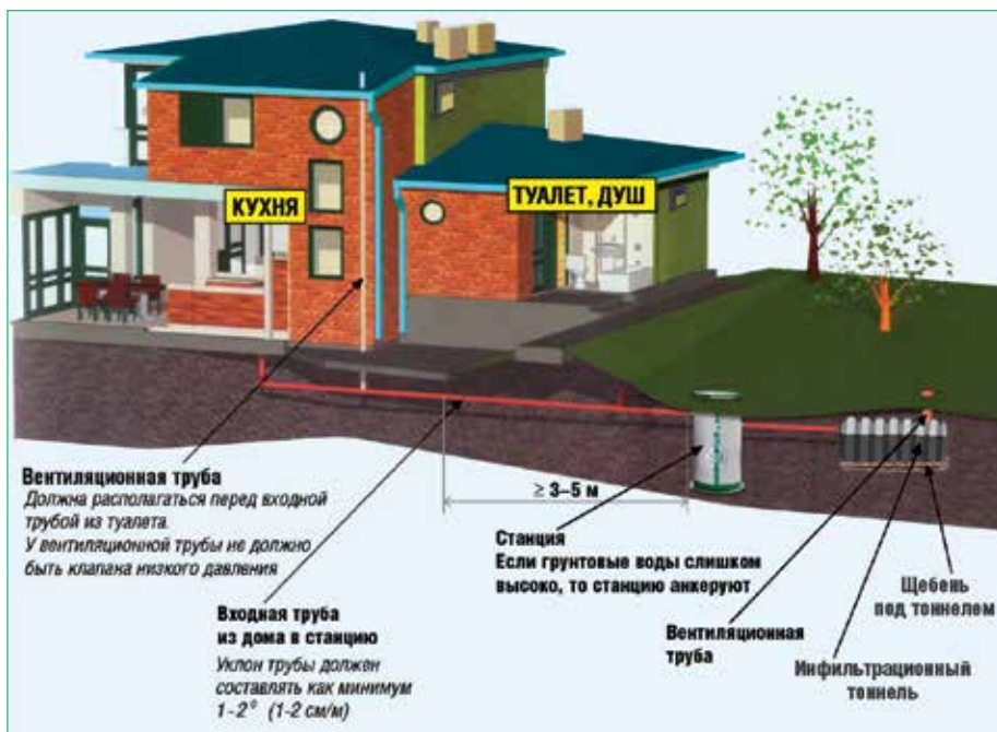
Рис. 2 Схема установки станции FloTenk-BioPurit
